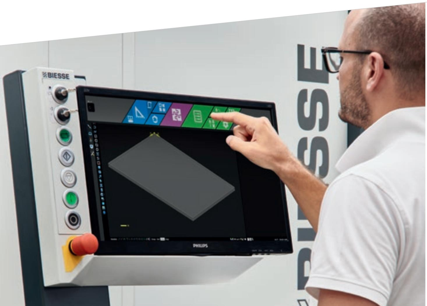
**bTouch est le nouvel écran tactile de 21,5" qui permet d'exécuter toutes les fonctions réalisées par la souris et par le clavier en assurant une interactivité directe entre l'utilisateur et le dispositif.**
