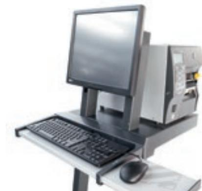
Identification et traçabilité du panneau dans le flux de production grâce à l'étiquetage **automatique ou manuel**.
